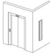
Vægmonteret på sidevæg
