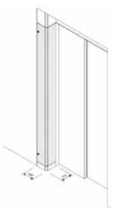
Wartungspaneel auf Türrahmen gesetzt: Edelstahl geschliffen (F), Edelstahl Karo (K), Edelstahl Leinen (M) oder Zinkal (Z)
