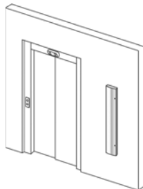
Wartungspaneel auf der Wand: Aluminium (A) oder Edelstahl geschliffen (F)
