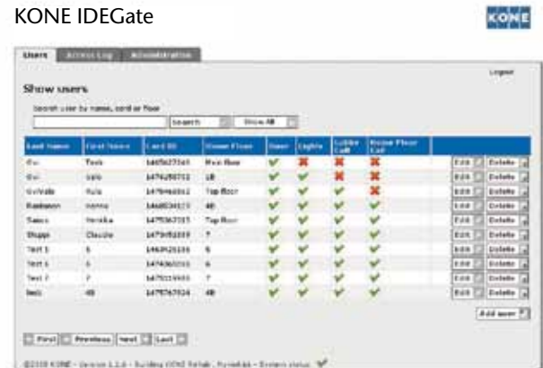
Met behulp van het bijgeleverde programma KONE IDEGate, kan een beheerder ofwel in het gebouw zelf ofwel op afstand de gevens beheren. Per elektronische sleutel kan afzonderlijk worden opgegeven welke opties men wilt hebben.
