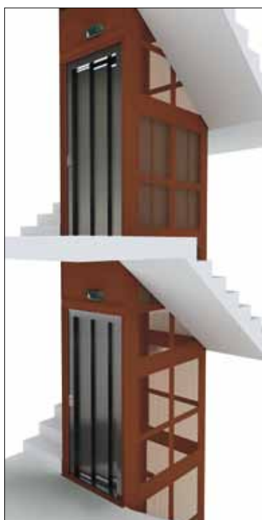
Stahl-Schachtgerüst mit Lochblech
