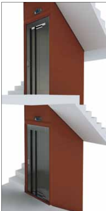
Stahl-Schachtgerüst mit Blechverkleidung
