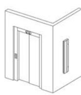
Tillträdespanel monterad på sidovägg
